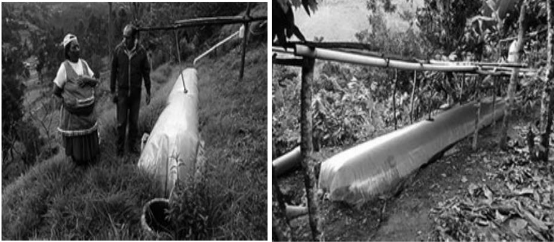
Ilustración 12. Biodigestores tubulares funcionando por más de tres años en Turi (Azuay) y en Las Lajas (El Oro) (Peláez y otros, 2015)
